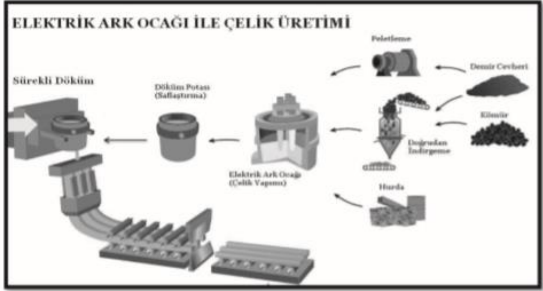
Şekil 3.3. EAO/doğrudan indirgenme ile çelik üretimi akım şeması [12]
