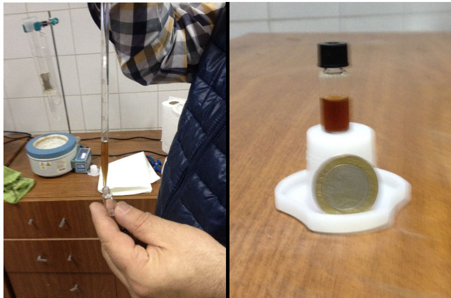
Resim 3. 10. Çözücünden ayrılan petrolün alınması işlemi ve şeyl petrolü
