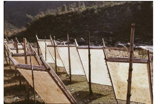
Foto. 4.3: İslam kâğıdının açık havada kurutulması ( http://soteriou.lib.uiowa.edu/ (07.11.2020))
