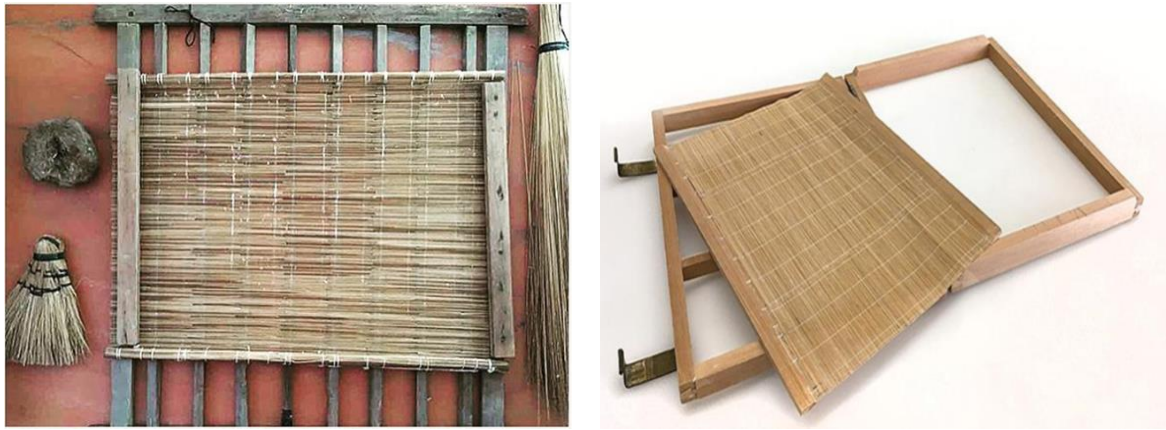
Foto. 2: Doğu Kâğıdı üretiminde kullanılan süzgeç örnekleri
