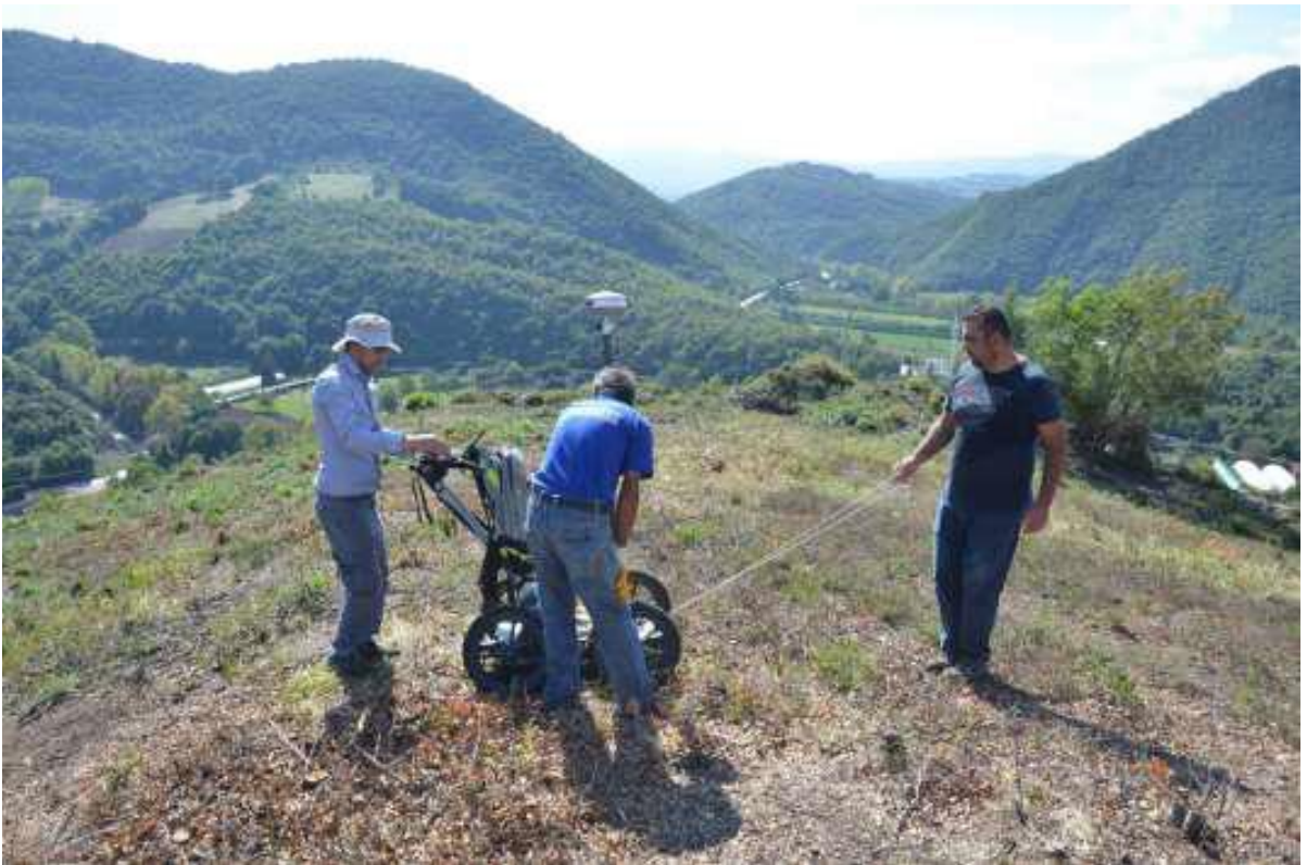
Foto. 12: Yapılan Jeoradar çalışmasından görünüm
