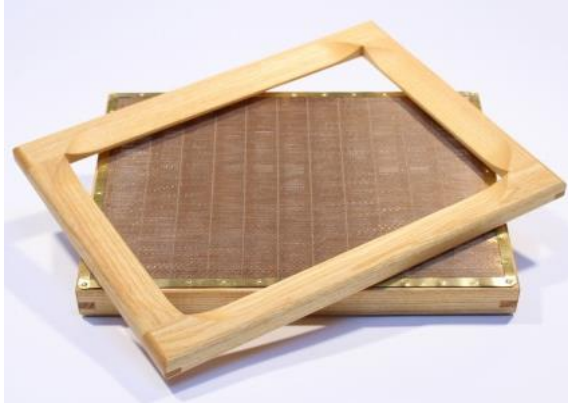
Foto. 7.1: Avrupa Kâğıdı üretiminde kullanılan iki parçadan oluşan süzgeç
