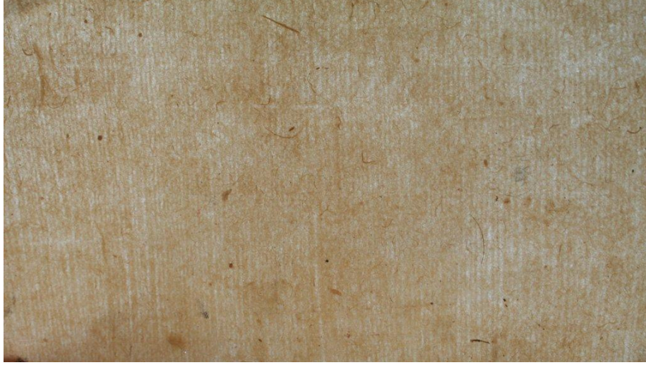
Foto. 6: Bir İslam kâğıdında heterojen dağılmış lifler ve silik süzgeç izleri
