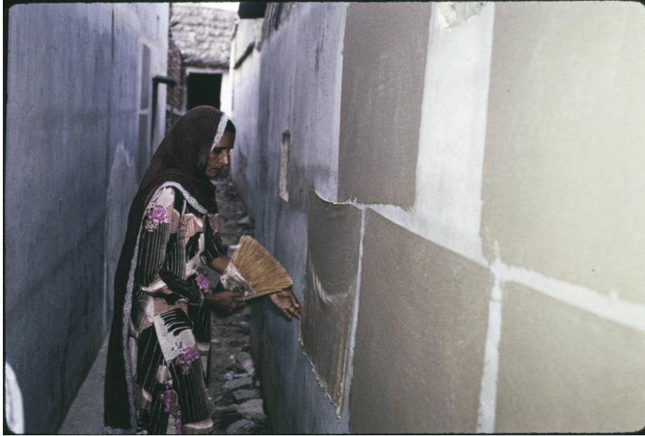
Foto. 3: Doğru kâğıdının duvarda gererek kurtulması ( http://soteriou.lib.uiowa.edu/E.T: 07.11.2020 ). Nemli haldeki ham kâğıtlar kurutma amacıyla duvar yüzeyine geniş fırça yardımıyla tutturulmaktadır.
