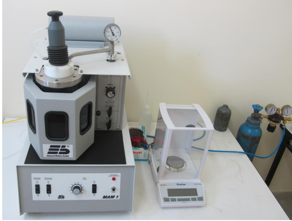
Şekil 3.1. Örneklerin üretilmesinde kullanılan ark fırını.
