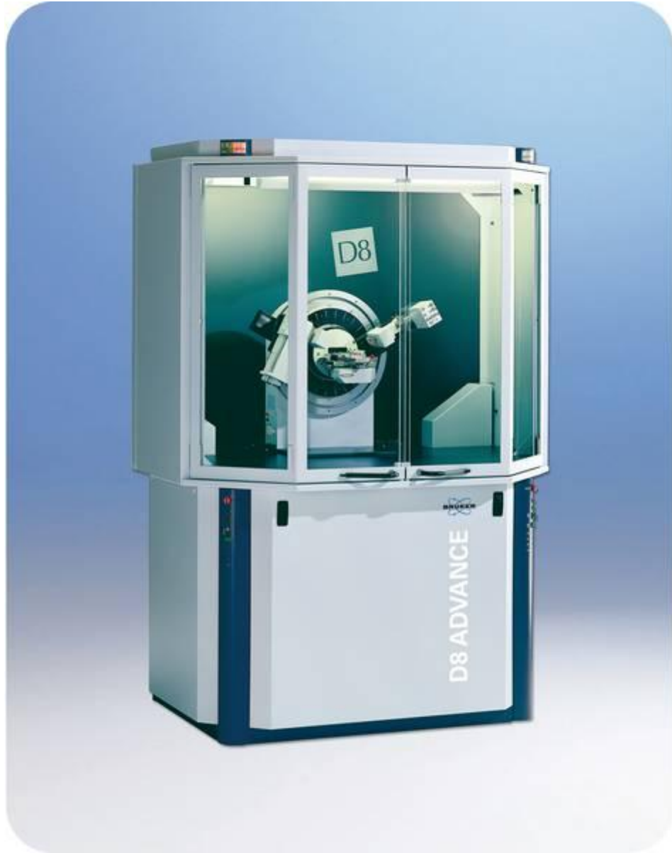
Şekil 3.3. Bruker D8 Advance X-ışını toz difraktometresi.
