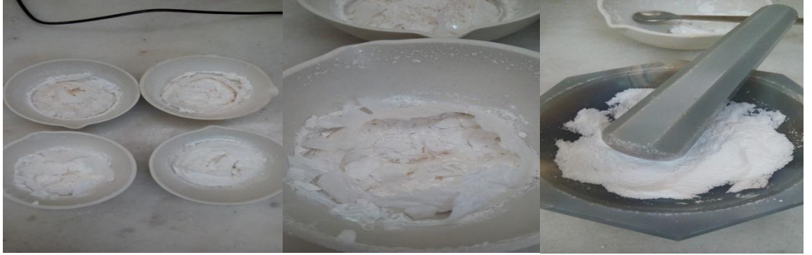
Resim 3.2 : Etüvde kurutulan Si katkılı Mg_2B_2O_5 malzemesi ve havanda öğütme
