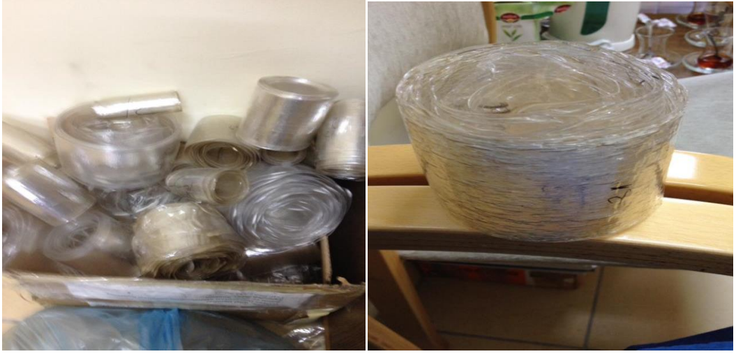
Resim 3.5: Film halinde çekilen katkılı PET numuneleri
