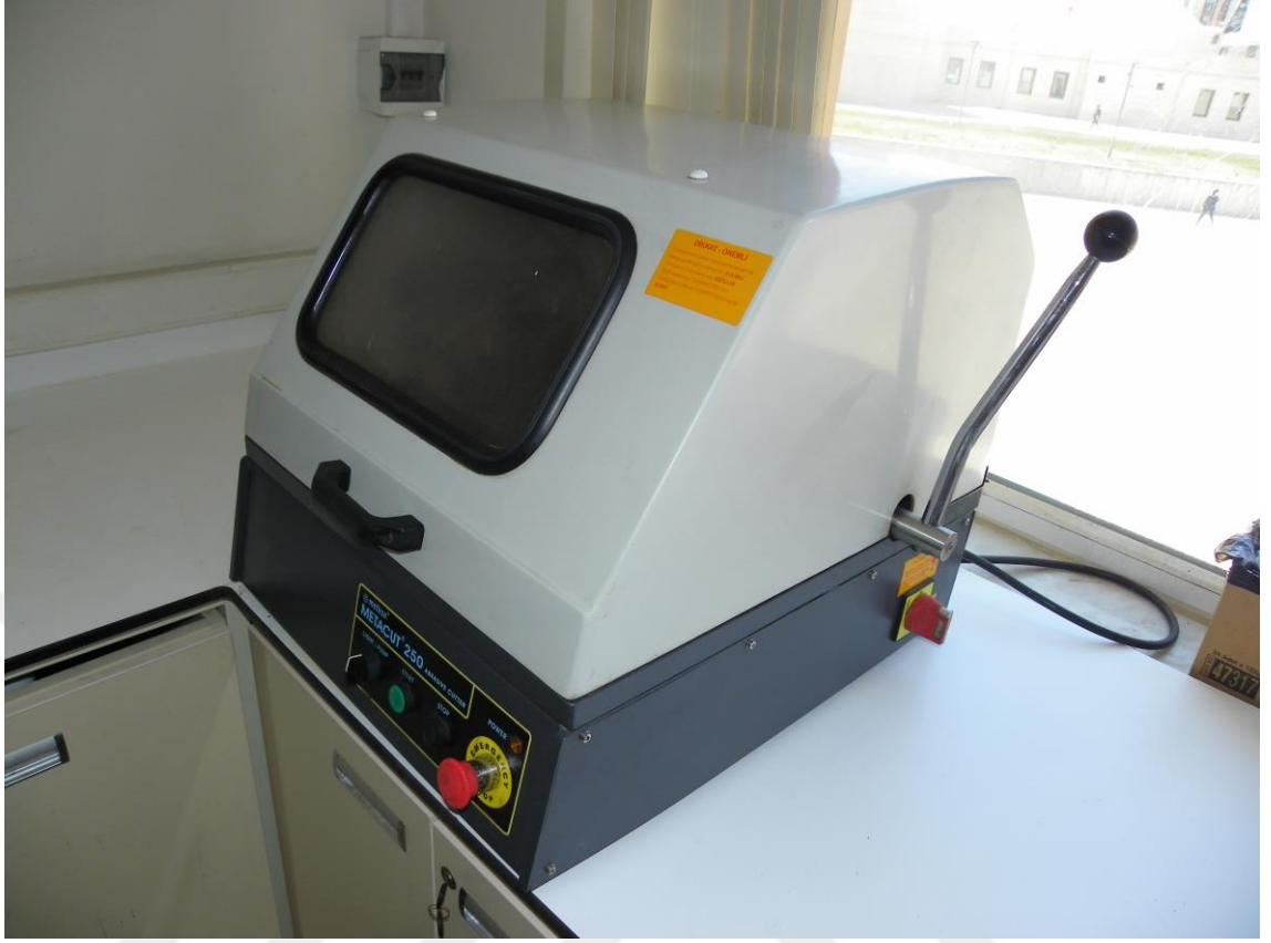
Şekil 4.3 Hassas numune kesme cihazı
