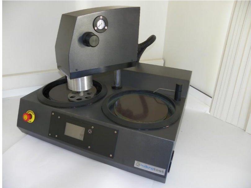
Şekil 4.6 Mikrotest yarı otomatik zımparalama ve parlatma cihazı
