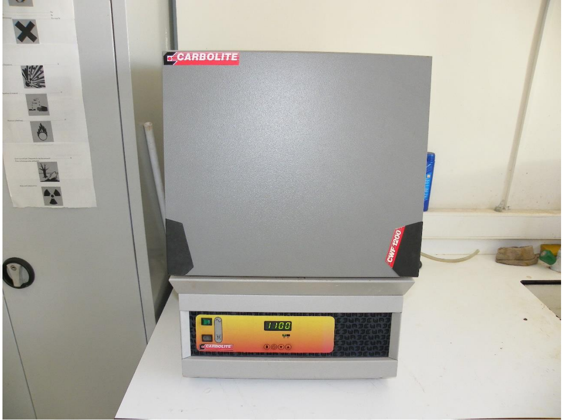
Şekil 4.2 Yüksek sıcaklık fırını
