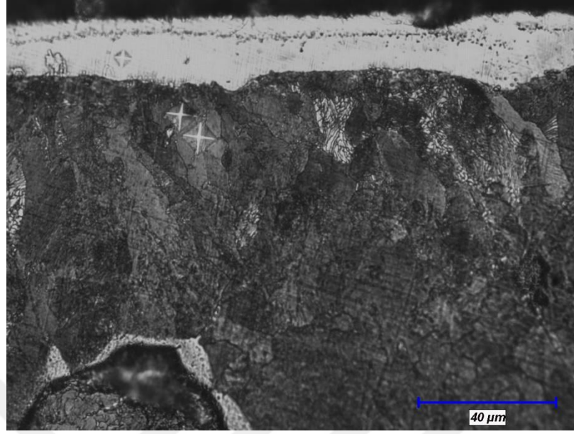
Şekil 5.17 Mikrosertlik izi fotoğrafı
