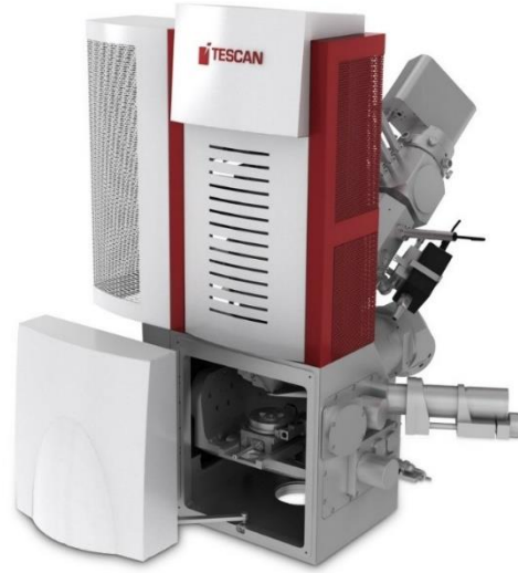
Şekil 4.8 Tescan MAIA3 XMU Elektron mikroskobu (SEM).
