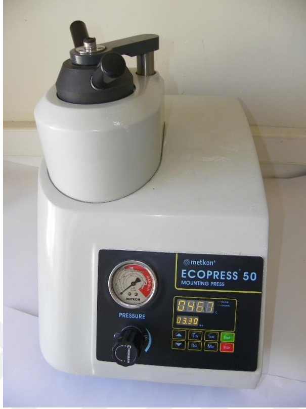
Şekil 4.5 Metkon Ecompress 50 sıcak bakalit kalıplama
