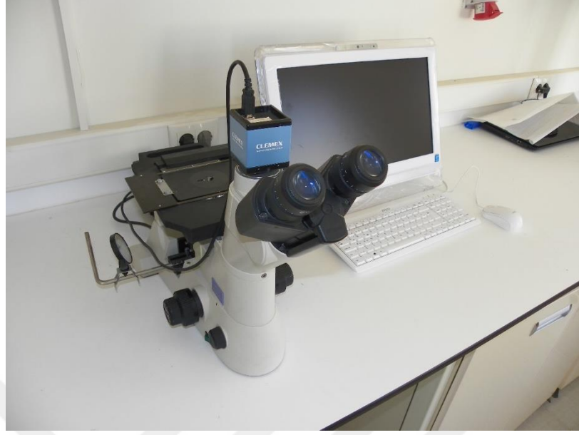
Şekil 4.7 Nikon MA 100 Ters Metal mikroskobu
