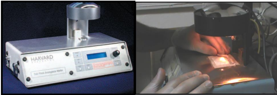
Şekil 5. Tail Flick test cihazı.
