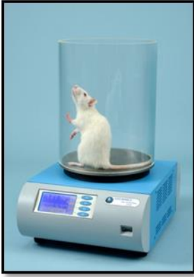
Şekil 6. Hot Plate test cihazı.
