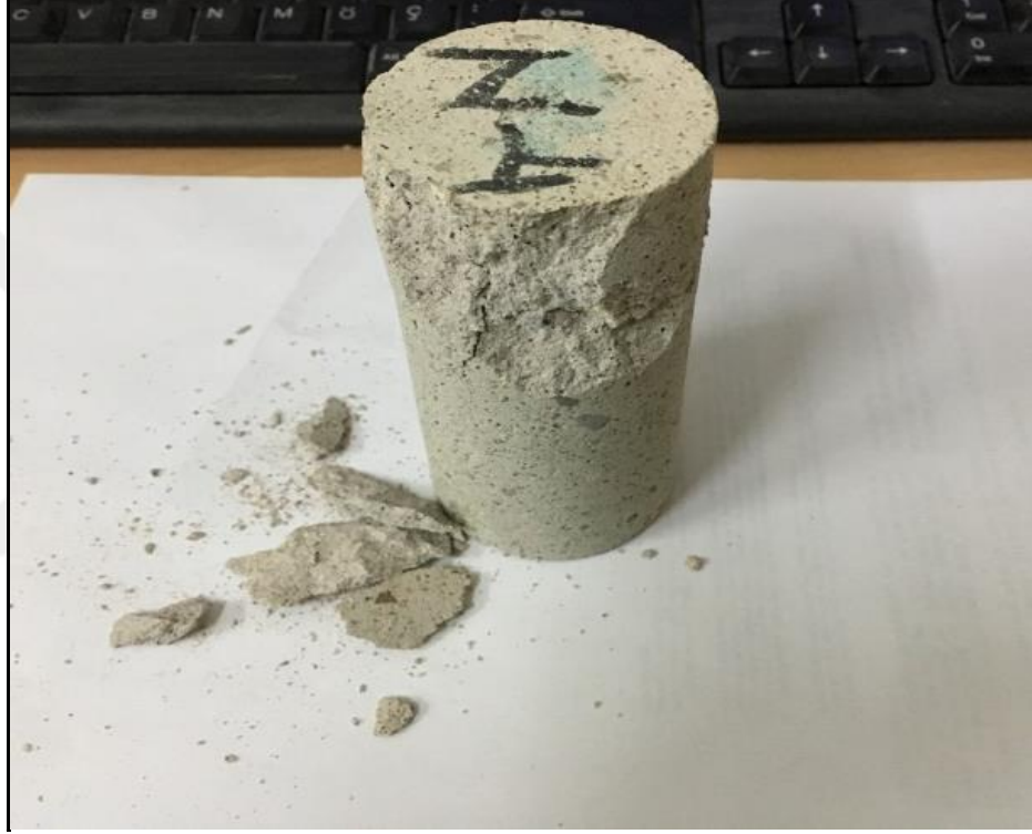
Şekil 3.6 Tek eksenli basınç dayanımı deneyi sonrası yenilen karot numunesi
