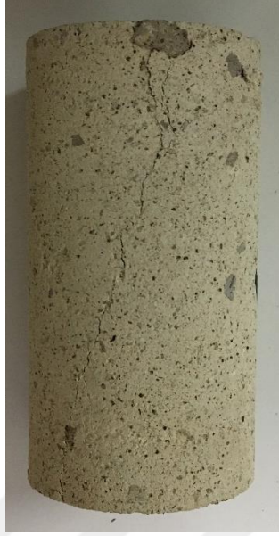
Şekil 3.3 İncelenen lokasyonlarda yer alan ignimbiritten alınan karot örneğinden bir görünüm
