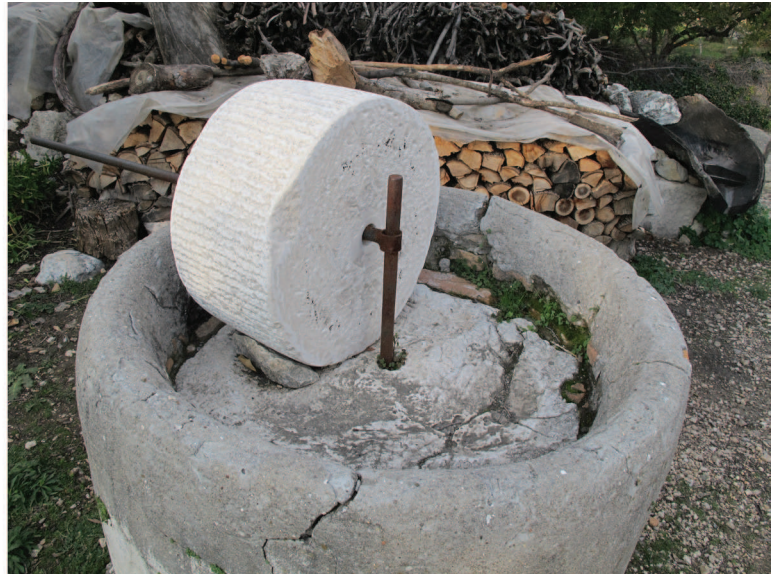
Resim 18: Beton tekneli modern pres düzeneği
