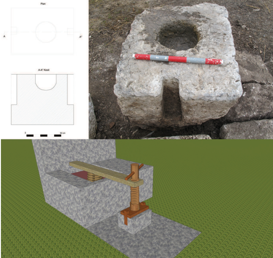
Resim 11: Kent bazilikası pres ağırlık taşı kesit ve model
