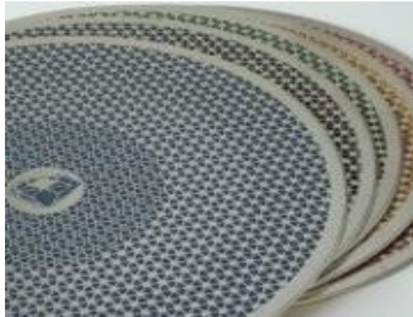
Şekil 5.5. Otomatik zımpara cihazında kullanılan diskler
