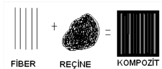
Şekil 1. Kompozit malzeme de kullanılan fiber ve reçine [1]
