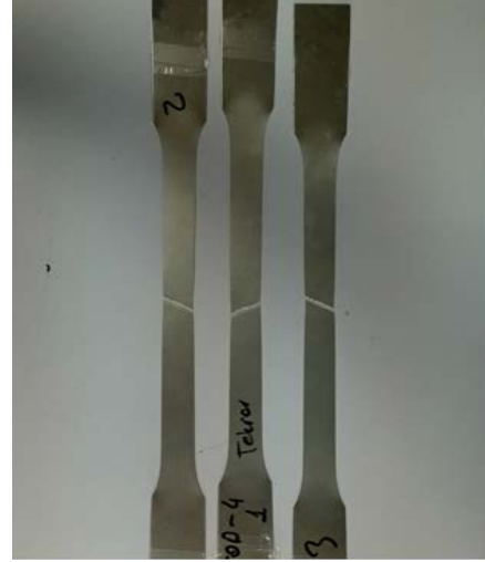
Şekil 7. Ekstansometre çatalları arası kopma gözlemlenen numuneler
