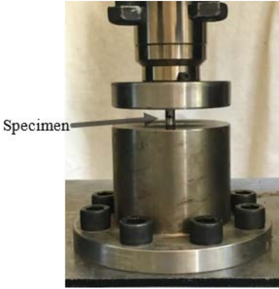
Şekil 2. Basma Deney düzeneęi.
