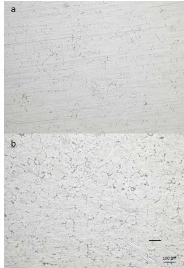
Şekil 1. Al-Mg/MgO kompozitin a) 700 °C, 1 % Mg, 0,5 % MgO b) 800 °C, 1 % Mg, 1 % MgO 10x büyütmede optik mikroskobu görüntüsü
