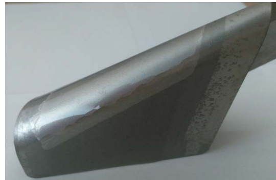
Şekil 3. Konik bükme testi uygulanmış numune
