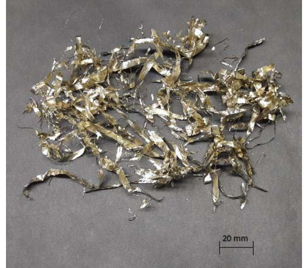
Şekil 2. Melt spinning yöntemiyle üretilen CuAlMn alaşımı şeritlerin fotoğraf görüntüsü.
