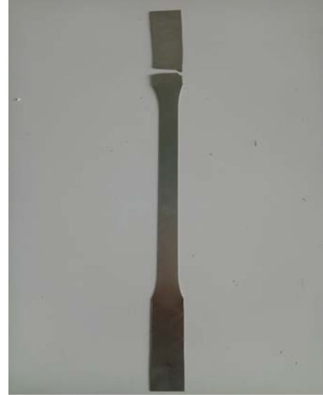
Şekil 8. Ekstansometre çatalları arası kopma gerçekleşmeyen numuneler
