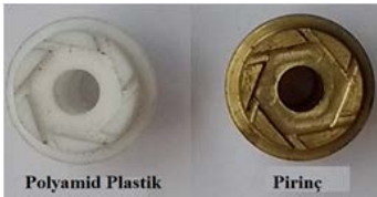
Şekil 4. Deneylerde kullanılan nozullar
