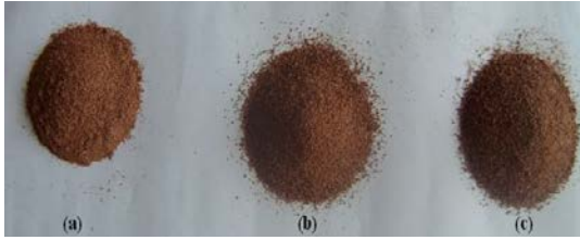
Şekil 1. Değişik Boyutlardaki Fındık Kabukları ((a) ince - 200-300 mikron, (b) orta - 300-400 mikron, (c) kalın - 400-600 mikron)
