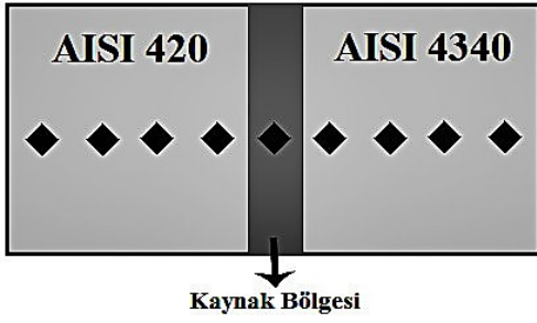
Şekil 3. Mikrosertlik ölçümlerin gerçekleştirildiği numunenin şematik görünümü
