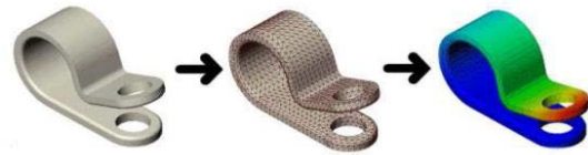
Şekil 1. Sonlu elemanlar yönteminin şematik açıklaması [11]
