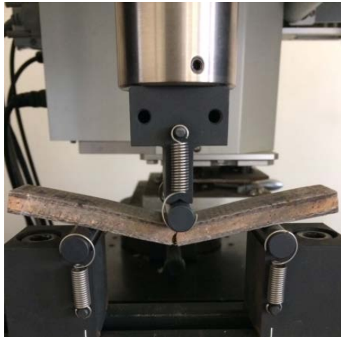
Şekil 2. Sandviç eğilme testi.
