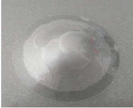
Şekil 4. Erichsen deformasyon testi uygulanmış numune
