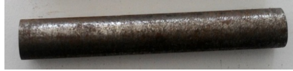
Şekil 2.1. GGG40 deney numunesinin makro resmi
