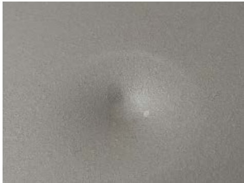
Şekil 5. Darbe direnci testi uygulanmış numune
