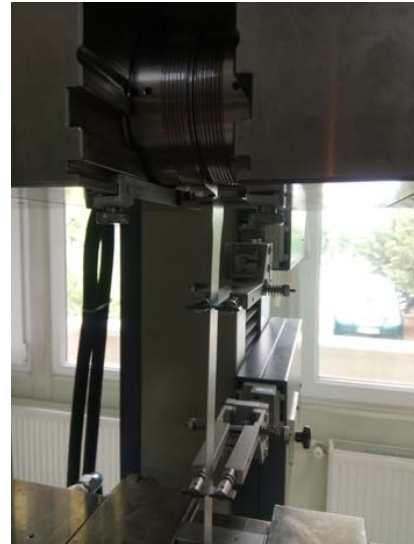
Şekil 2. Çekme deneyi makinası ve numunenin pozisyonu
