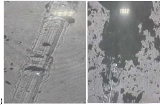
Şekil-5 B2 numunenin çizik test sonrası yüzeyde ilk kaplamanın kalktığı(a) ve kaplamanın tamamen kalktığı(b) optik mikroskop görüntüleri
