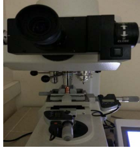
Şekil 4. Mitutoyo sertlik ölçüm test cihazı.
