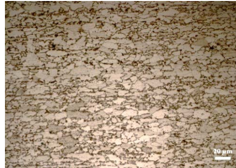
Şekil 1. DP600 çeliğinin mikroyapı görüntüsü
