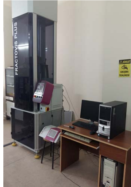
Şekil 3. CEAST Fractovis düşük hızlı ağırlık düşürme darbe test cihazı.
