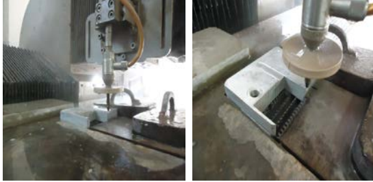
Şekil 2. AlMg3/SiCp kompozit bloklardan ASJ tezgahı ile numune kesme işlemi
