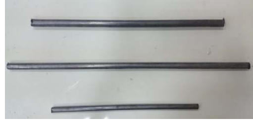
Şekil 3. Kesme deneyinde kullanılan numuneler
