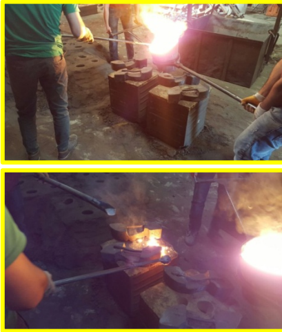
Şekil 1. 42CrMo 4 çeliğinin kum kalıba döküm işlemi
