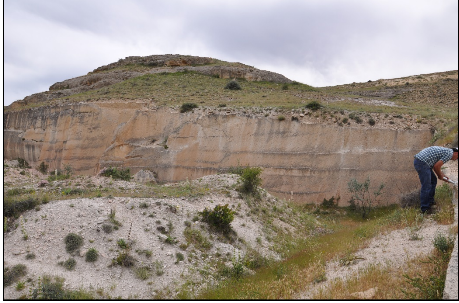
Resim4.12. Arazide bloklar üzerinde gerçekleştirilen Schmidt sertlik deneyi
