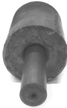
Şekil 3.11. Numune dökümünde kullanılan huni.
