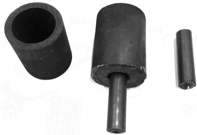
Şekil 3.8. Grafitten yapılmış olan pota, huni ve numune kalıbının fotoğrafı.
