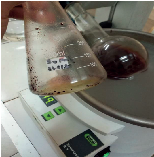
Resim 3. 2: Sumak bitkisi ile evaporatör cihazında alkol uçurma işlemi yapılışı
