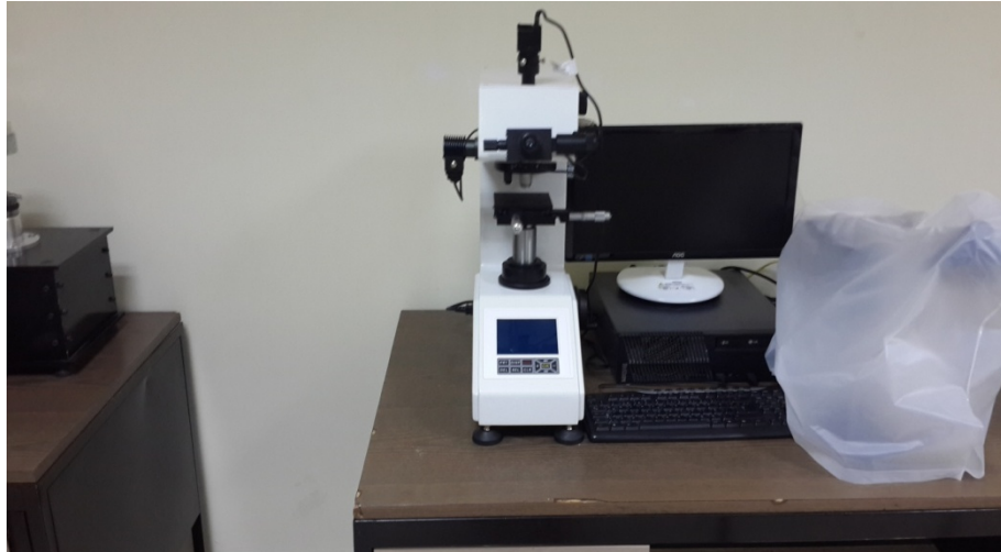
Şekil 6.4 Mikro sertliklerin alındığı sertlik cihazı.
