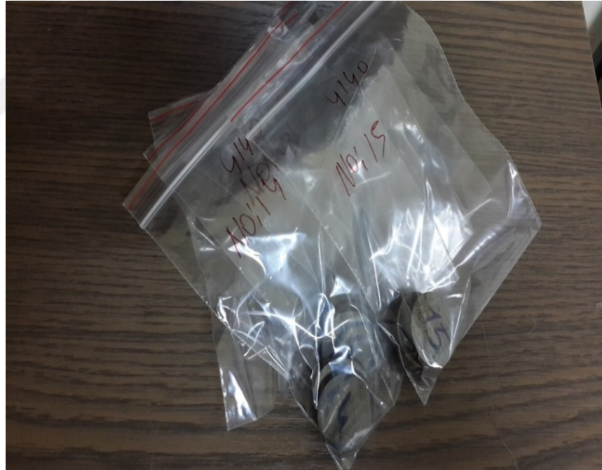
Şekil 6.8 AISI 4140 çeliğinden hazırlanan 25x5 mm çapında aşınma deney numuneleri.
