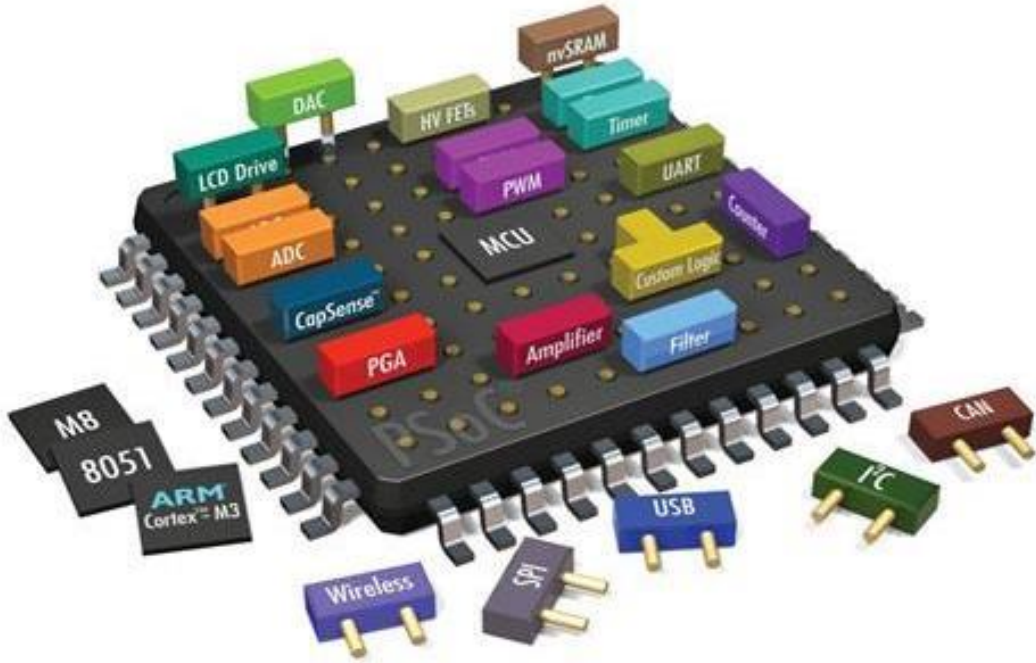
Şekil 2.5. PSoC Mikrodenetleyici İç Yapısı [7]
