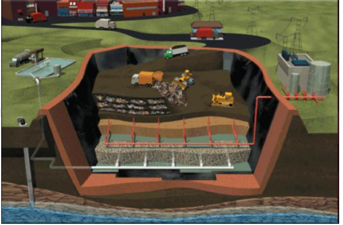
Şekil 2.2. Düzenli depolama sahası kesit görünüşü [9]
