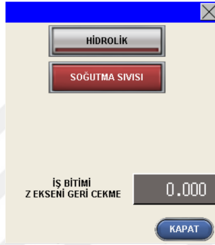
Şekil 5.9. Manuel mod kontroller penceresi
