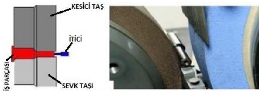
Şekil 2.21. Dayamalı puntasız taşlama [11]
