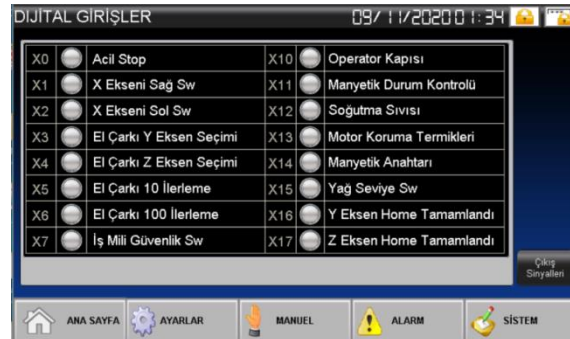
Şekil 5.19. Sistem sayfası girişleri izleme bölümü
