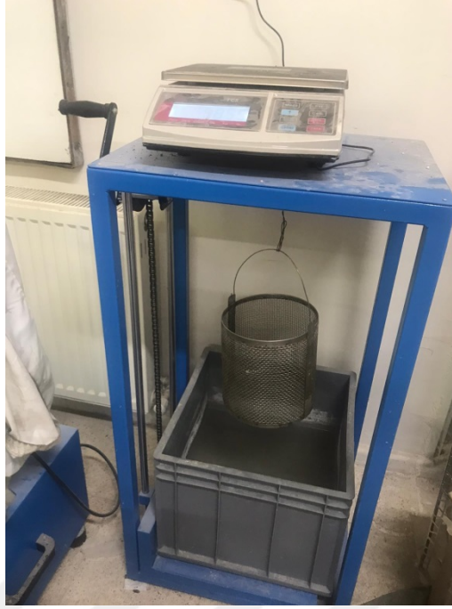
Şekil 2.10. Su emme-boşluk ölçümü
