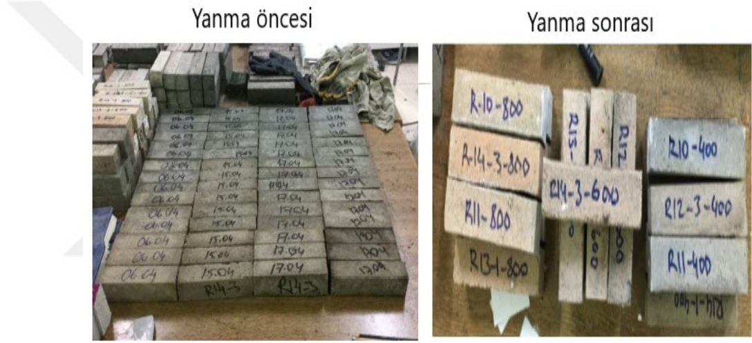
Şekil 3.4. Yüksek sıcaklık öncesi ve sonrası Numune Görselleri
