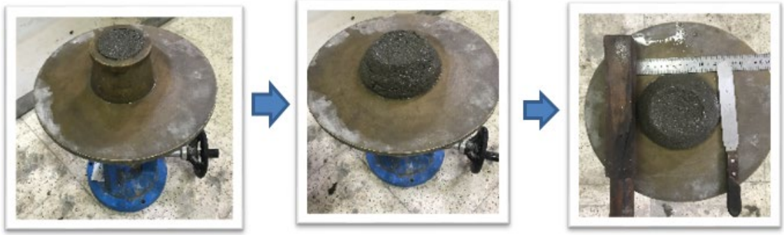
Şekil 2.7. Taze harç karışımları için yayılma tablası (işlenebilirlik) deneyi
