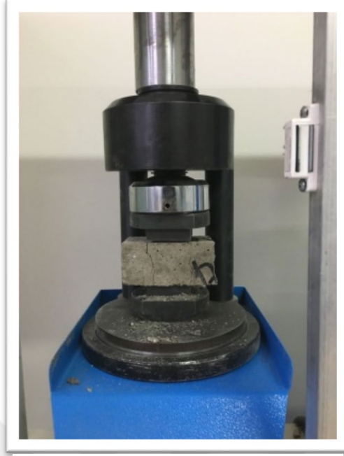
Şekil 2.9. Basınç Dayanımı Deneyi
