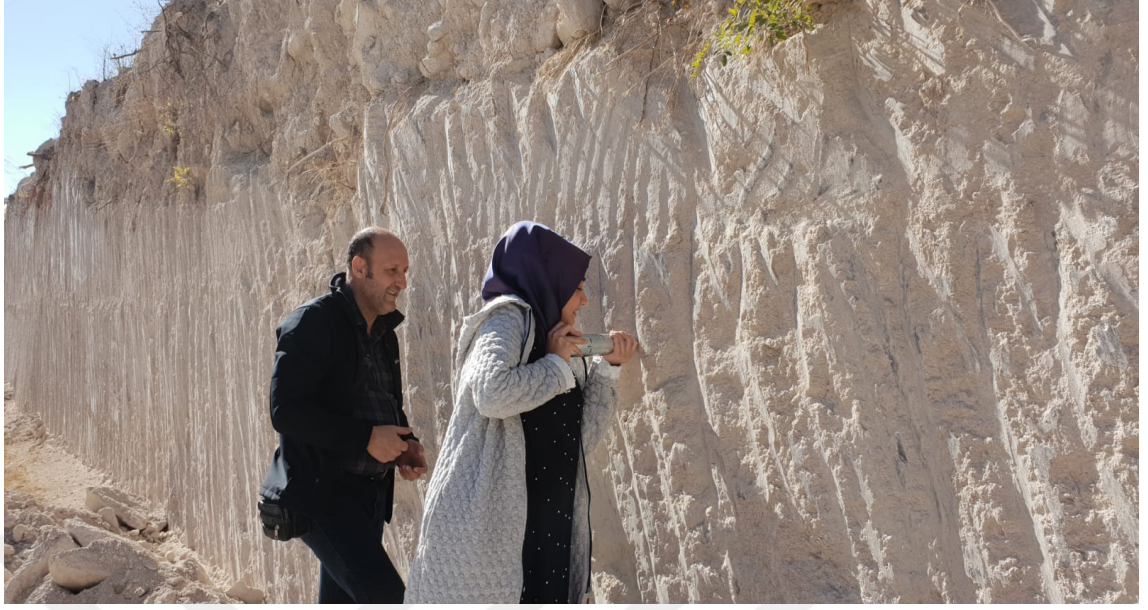
Resim 3.3 Depoların oluşturulduđu kaya kütlesinde Schmidt çekici deneyi yapımı
