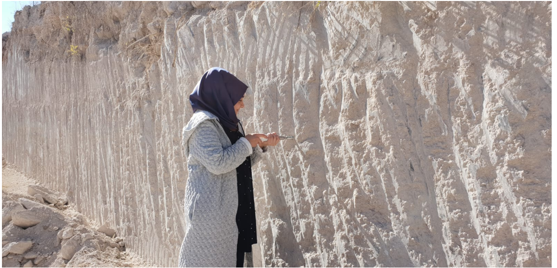
Resim 3.4 Depoların oluşturulduđu kaya kütlesinde iğne penetrometresi deneyi yapımı
