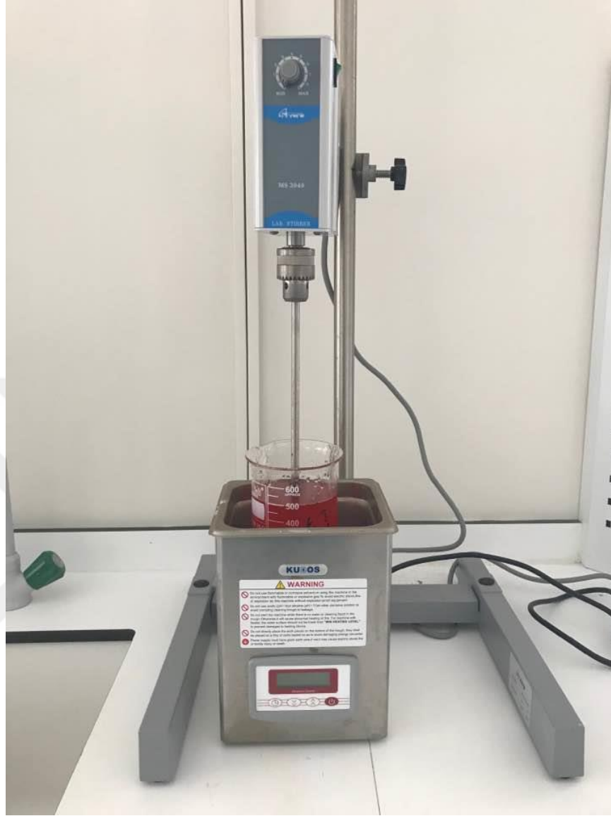
Resim 3.2. Ultrases ışınımlı Fenton prosesi düzeneđi
