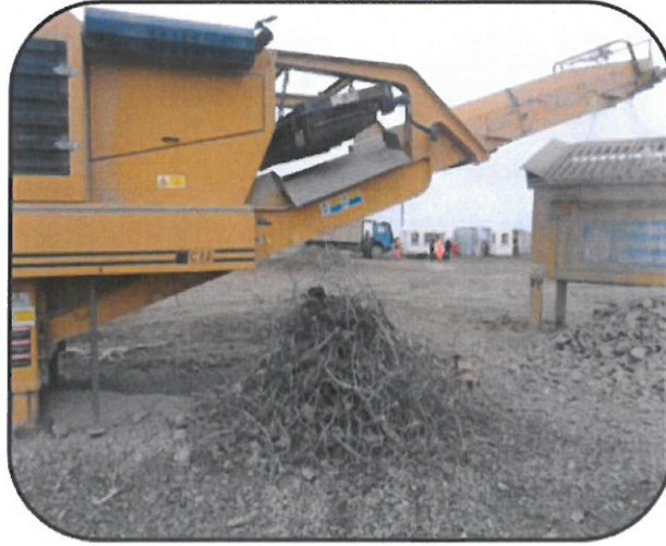
Resim 3.13. İnşaat ve yıkıntı atıklarından demirin ayrışması [8]
