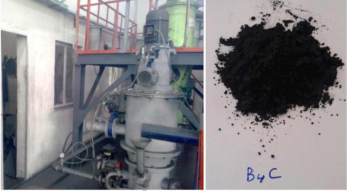
Şekil 3.3. Jetmil Öğütme Sistemi ve elde edilen tozlar
