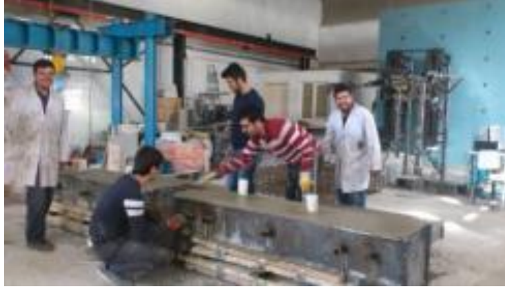
Şekil 2. Numune betonunun döküm aşaması
