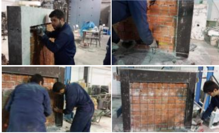
Şekil 4. Numune üzerinde hasır donatının ankraj çubuklarının epoksi yardımıyla yerleştirilmesi
