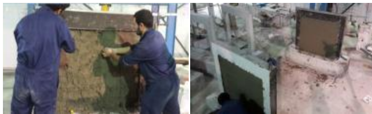
Şekil 5. Hasır donatı üzerine hazırlanan harç karışımının uygulanması
