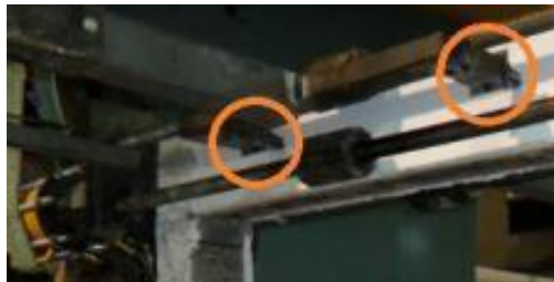
Şekil 8. Numuneye yerlestirilen kayar mesnetler
