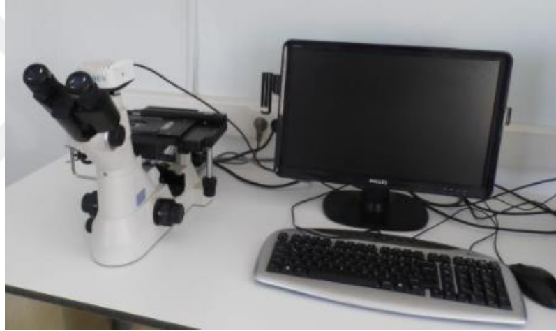
Şekil 3.17. Optik mikroskop ve CCD kameradan oluşan görüntü sistemi [107]
