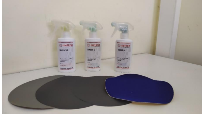
Şekil 3.21. Parlatma işleminde kullanılan zımpara, keçe ve süspansiyonlar [107]
