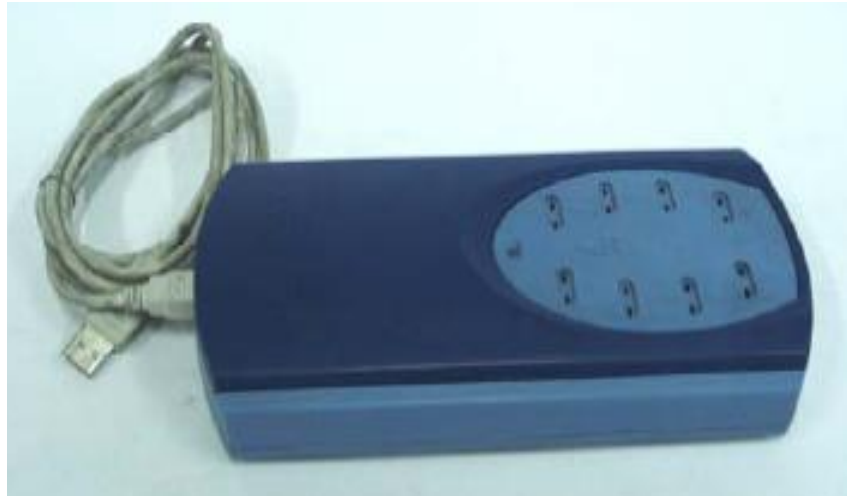
Şekil 3.14. Sıcaklık ölçümlerinin yapan ve kaydedilmesini sağlayan cihaz [111]
