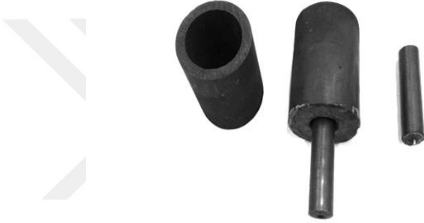
Şekil 3.7. Grafit malzemedен yapılan pota, huni ve numune kalıbı [108]
