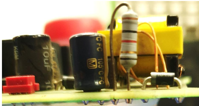
Şekil 1.3. Pim geçiş deliği kullanılarak yapılan baskılı devre kartı
