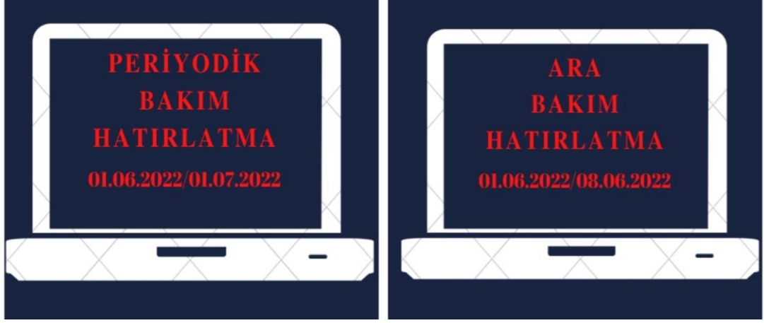
Şekil 3.8. Araç Bakımları İçin Hatırlatıcı Elektronik Poka-Yoke Sinyal Örneği
