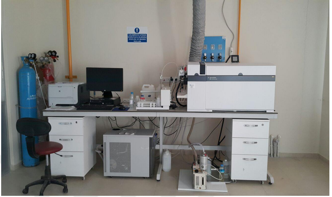
Resim 3.3 Süt örneklerinin ağır metal tayininde kullanılan ICP-MS
