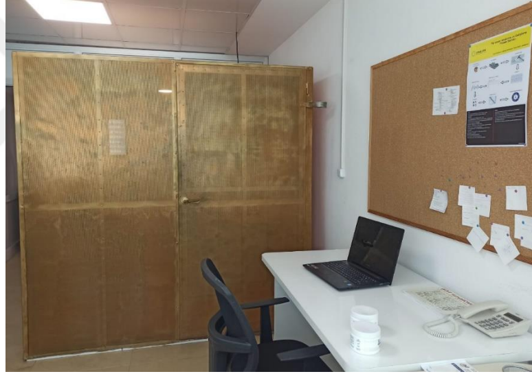
Resim 3.1. Deneyin Gerçekleştirildiği Faraday Kafesi'nin Dıştan Görüntüsü
