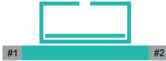
Şekil 2.9. '10' bit kodlu eş yönlü ayırık halka rezonatör tasarımı
