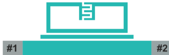
Şekil 2.7. '01' bit kodlu eş yönlü ayırık halka rezonatör tasarımı
