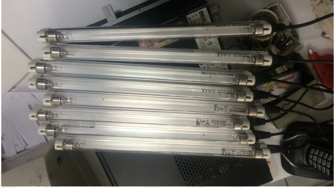
Resim 5.3. Osram 8 adet UV-C (254 nm) tipi ultraviyole lamba
