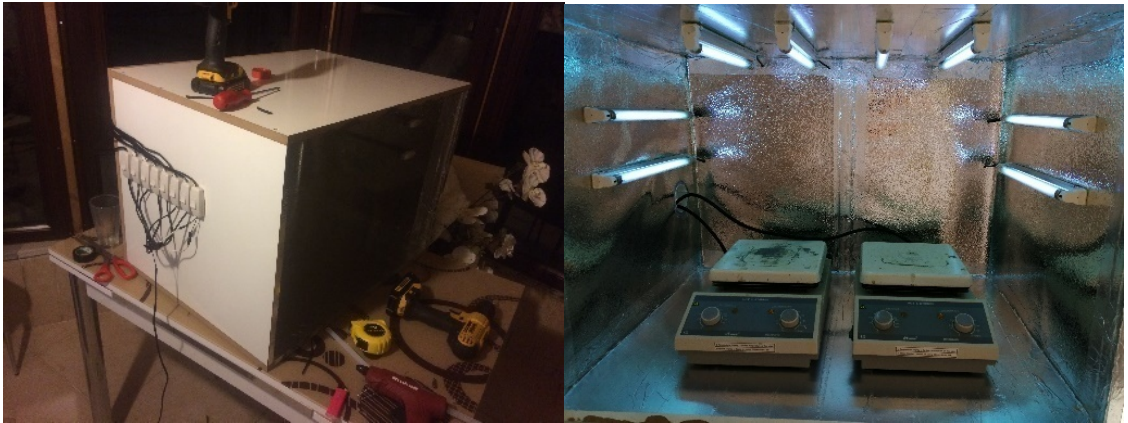
Resim 5.4. Foto-Fenton reaktörü (UV kabin)
