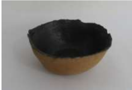
Şekil 8: Şekil 3B'deki astar kullanılmıştır. Şamot bünye. Pişirim sıcaklığı 1200°C'dir.
