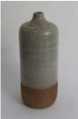
Şekil 9: Şekil 4B'deki astar kullanılmıştır. Şamot bünye. Pişirim sıcaklığı 1200°C'dir.
