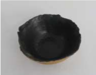
Şekil 8: Şekil 3B'deki astar kullanılmıştır. Şamot bünye. Pişirim sıcaklığı 1200°C'dir.
