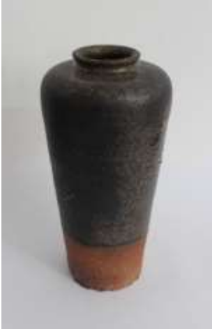
Şekil 6: Şekil 1B'deki astar kullanılmıştır. Şamot bünye. Pişirim sıcaklığı 1200°C'dir.
