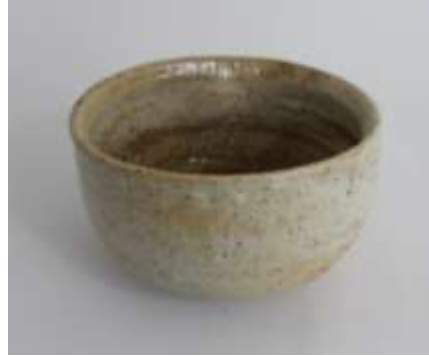
Şekil 7: Şekil 2A'daki astar kullanılmıştır. Porselen bünye. Pişirim sıcaklığı 1200°C'dir.
