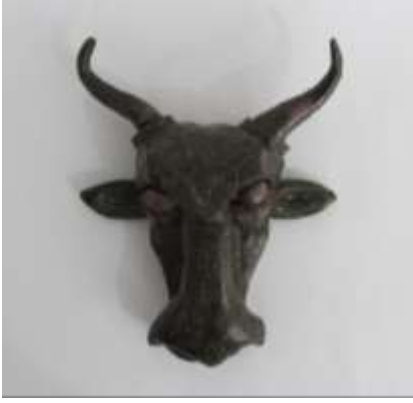
Şekil 10: Şekil 5B'deki astar kullanılmıştır. Şamot bünye. Pişirim sıcaklığı 1200°C'dir.
