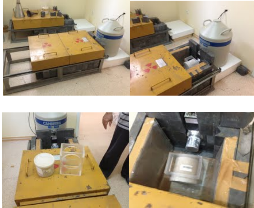
Resim 3.2. Radyoaktivite ölçümünde kullanılan HPGe dedektörlü gama spektrometresi
