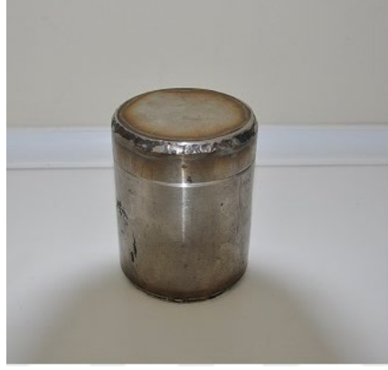
Resim 3.1. Tuz Banyosunda TRD Yönteminde Kullanılacak Paslanmaz Çelik Pota
