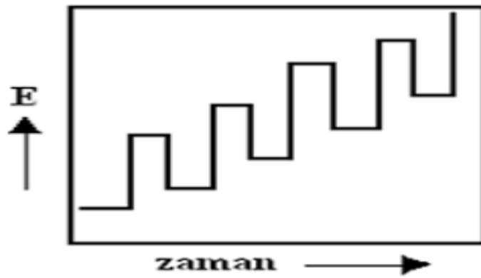
Şekil 2. 2. Diferansiyel puls voltametrisinde puls tipi uyarma sinyalinin dalga şekli
