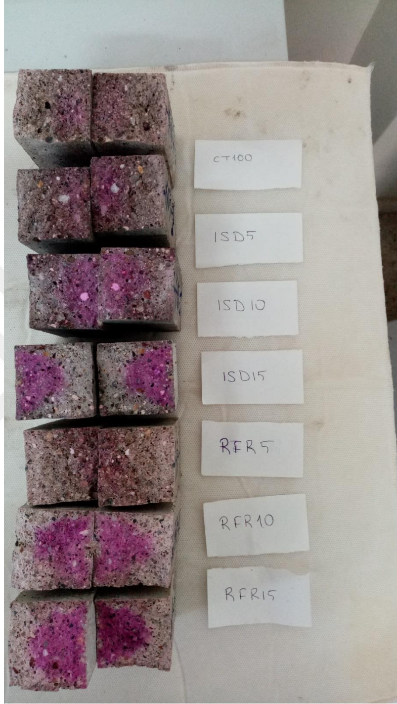
Şekil 3. 11 Numunelerin 30 günlük karbonatlaşma görüntüsü
