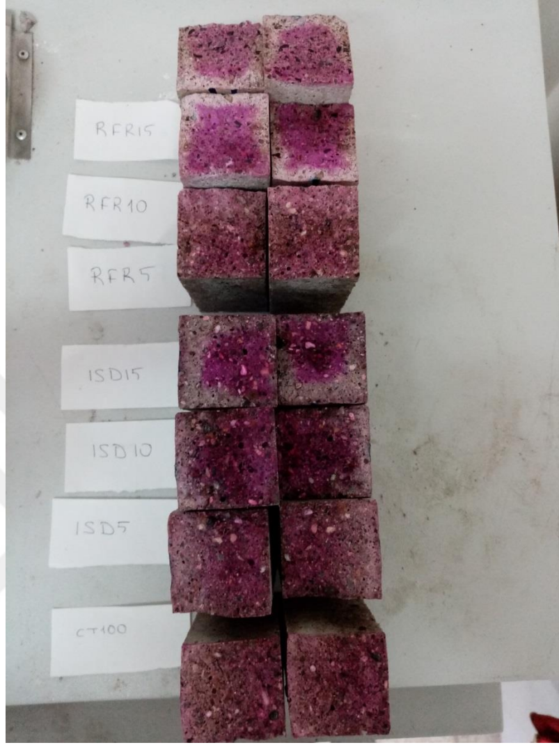
Şekil 3. 12 Numunelerin 90 günlük karbonatlaşma görüntüsü
