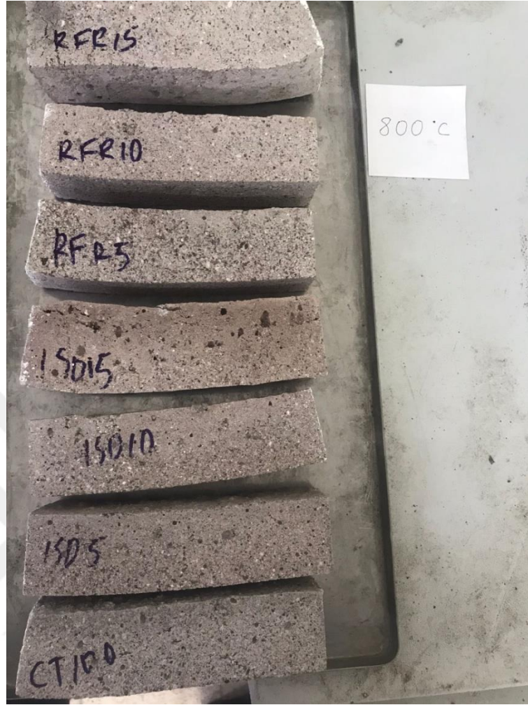
Şekil 3. 8 800 °C sonrası numunelerin görünüşü
