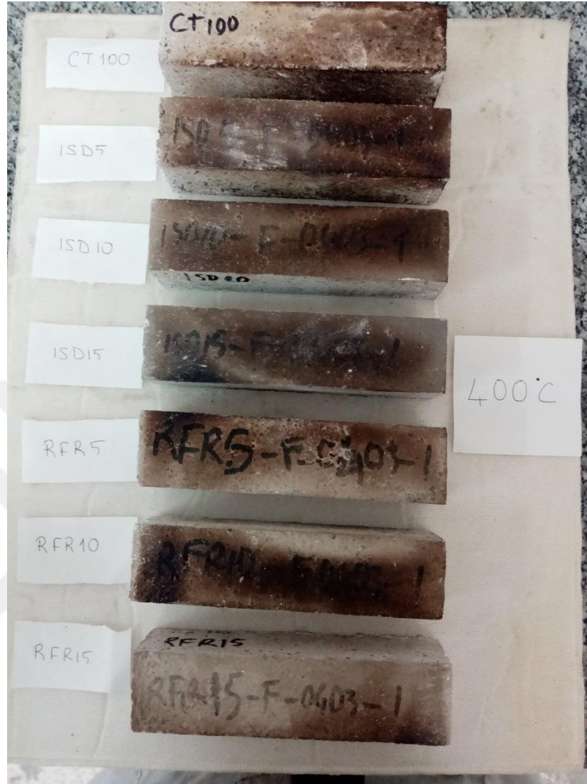
Şekil 3. 6 400°C sonrası numunelerin görünüşü
