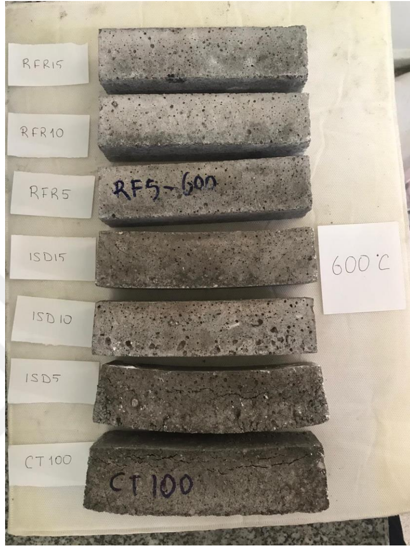
Şekil 3. 7 600 °C sonrası numunelerin görünüşü
