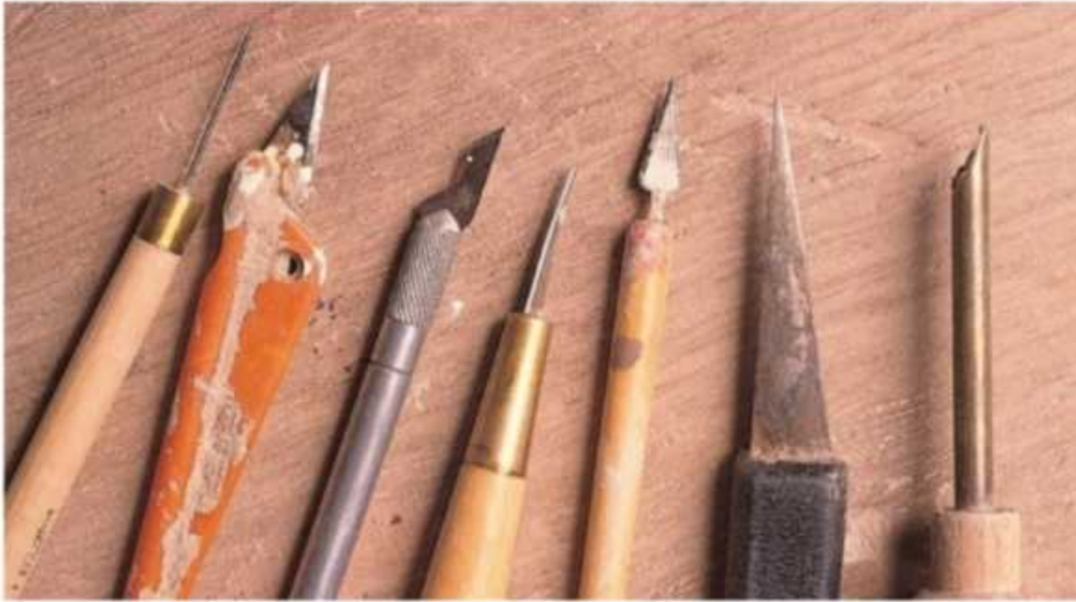
Şekil 6. Ajur dekoru uygulamasında kullanılabilecek çeşitli kesici aletler (Scott, 2006: 266)
