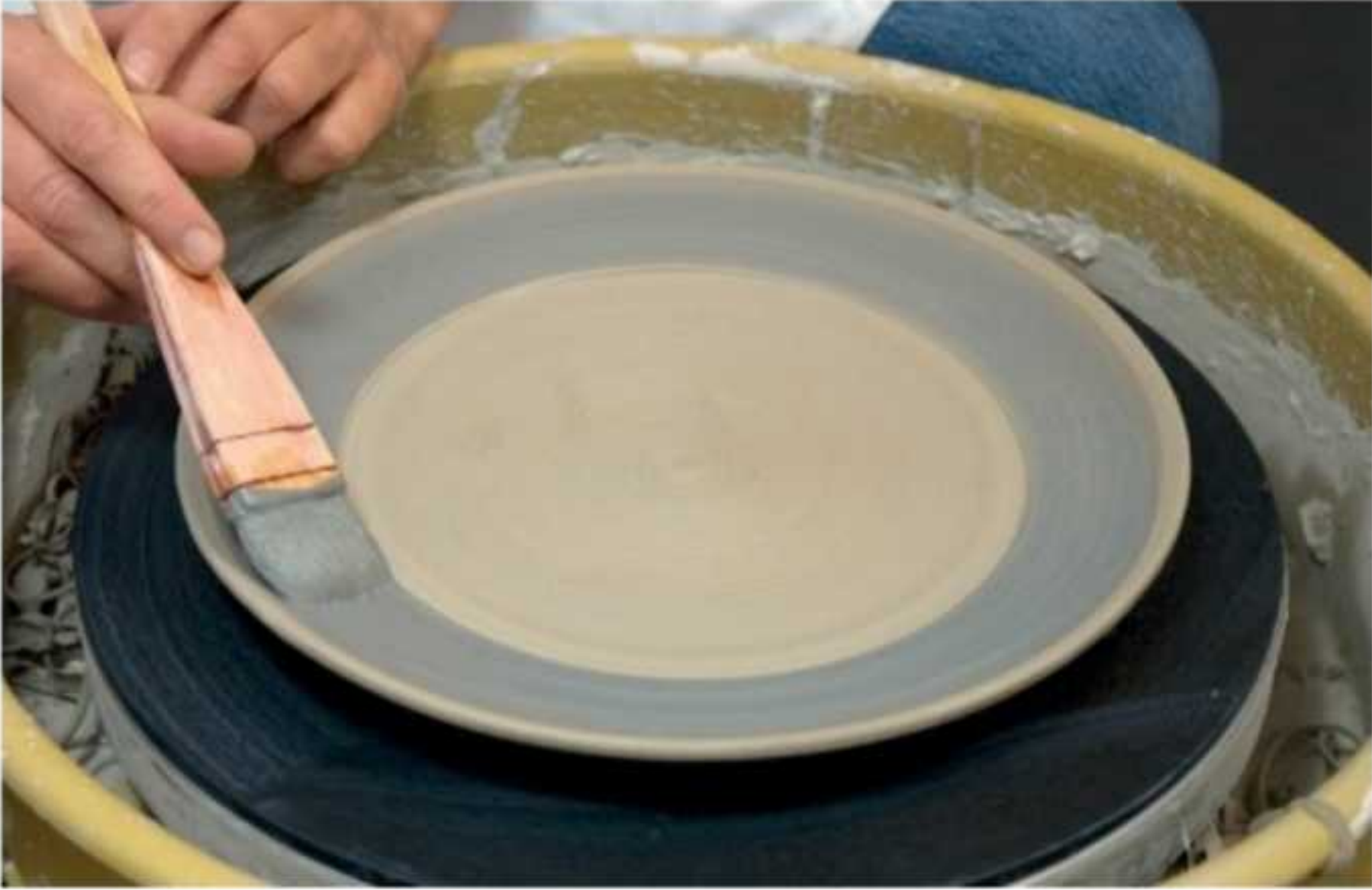
Şekil 2. Turnet üzerinde dönerken geniş fırça ile astar uygulaması (Landberger ve Lundin, 2012: 156)
