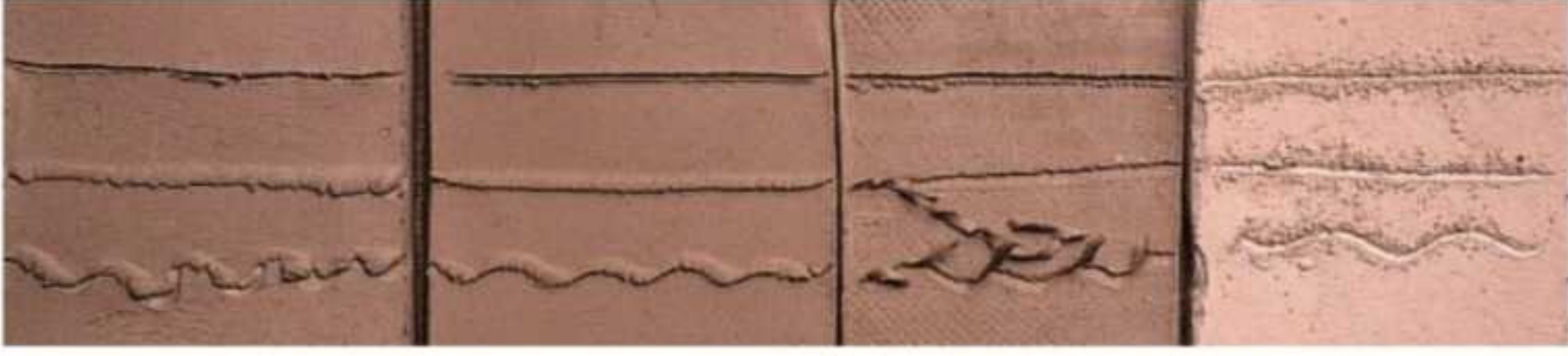
Şekil 4. Yumuşaktan kuruya doğru değişen neme sahip kil bünyelerinde aynı kazıma çizgilerinin etkileri. Özellikle deri sertliğindeki bünyede kazıma talaşlarının kilden temiz bir şekilde ayrıldığı görülmektedir (Scott, 2006: 231).
