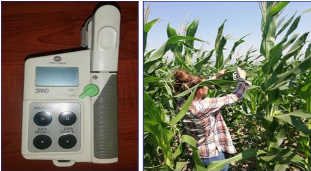
Şekil 2.166. SPAD-502 (Minolta Co, Tokyo, Japonya) taşınabilir klorofilmetre ve denemede klorofil okumalarına ait görüntüler
