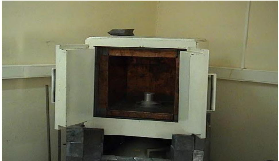
Şekil 3.4. Saf germanyum detektörlü gama spektrometrik cihazı çalışma düzeneği (ÇNAEM laboratuvarı)
