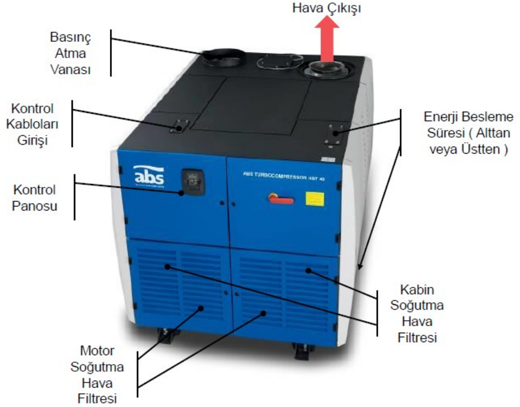
Şekil 3.8. Yeni nesil manyetik yataklı turbo blower aksamaları [6]
