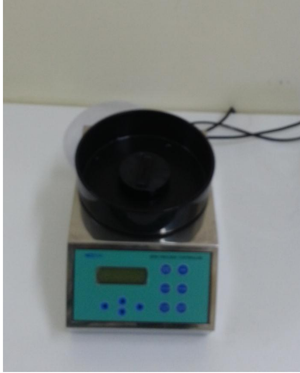
Resim 3.3. Döndürerek kaplama cihazı
