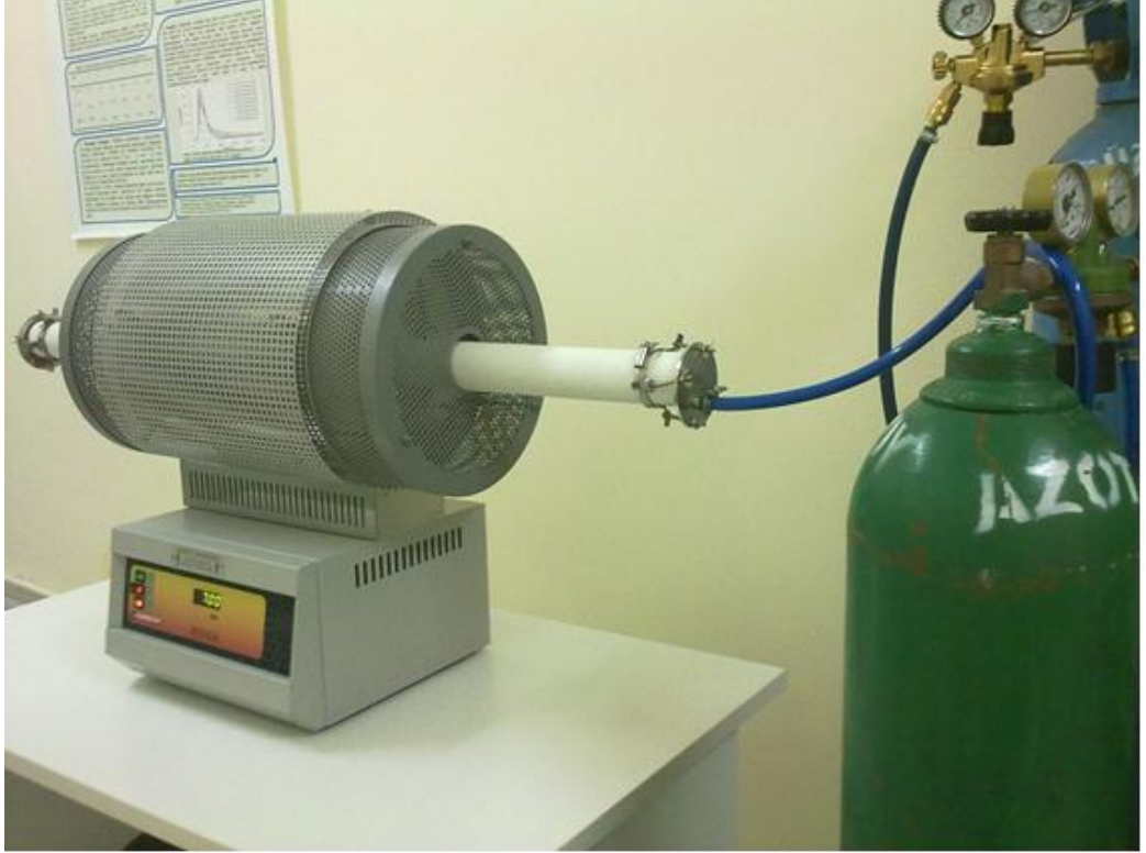
Resim 3.4. Azot gazı bağlanmış yüksek sıcaklık tüp fırın
