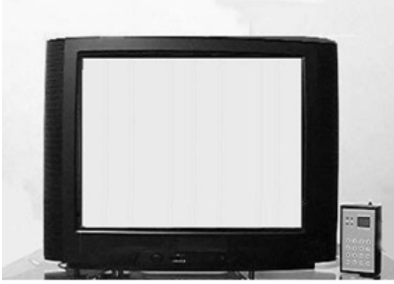
Şekil 2. Tuş takımı kontrollü televizyon deney seti örneği (Italtec Technical Training System, 2009).
