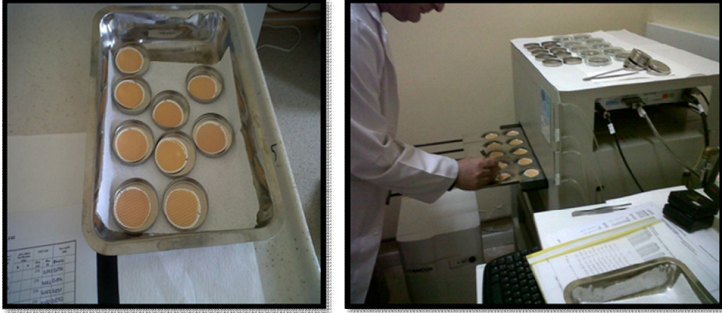
Şekil 3.7. Planşetlere yerleştirilen filtrelerin, ölçme işlemi için sayım sistemine alınması.
