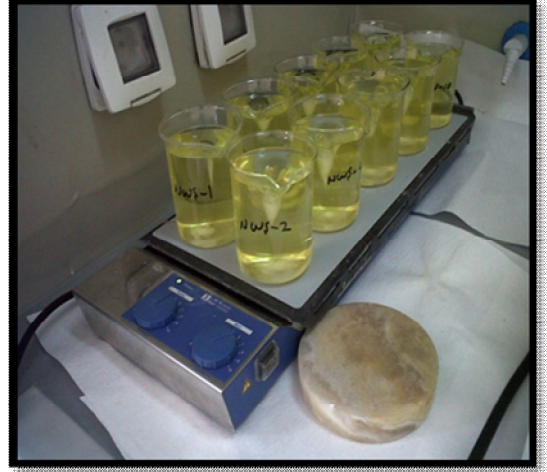
Şekil 3.4 Beherler ısıtıcı/magnetik karıştırıcı üzerine konur ve sülfirik asit, bromocresol purple indikatör çözeltisi ilavesi
