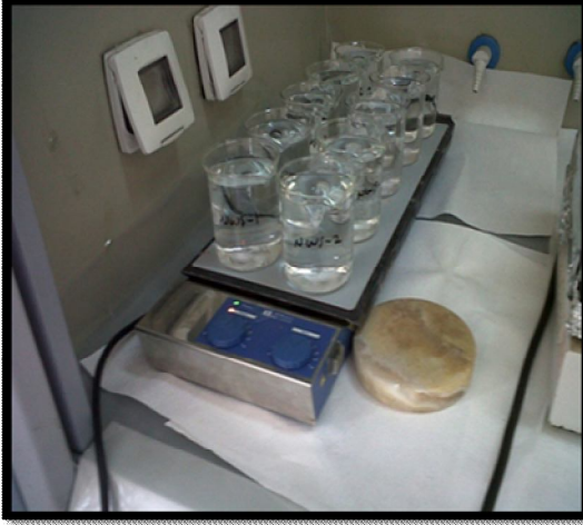
Şekil 3.4 Beherler ısıtıcı/magnetik karıştırıcı üzerine konur ve sülfirik asit, bromocresol purple indikatör çözeltisi ilavesi
