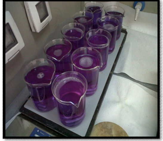
Şekil 3.4 Beherler ısıtıcı/magnetik karıştırıcı üzerine konur ve sülfirik asit, bromocresol purple indikatör çözeltisi ilavesi
