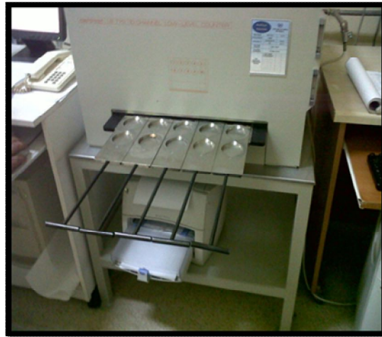
Şekil 3.3. Berthold LB 770 markalı gaz orantılı \alpha/\beta sayacı
