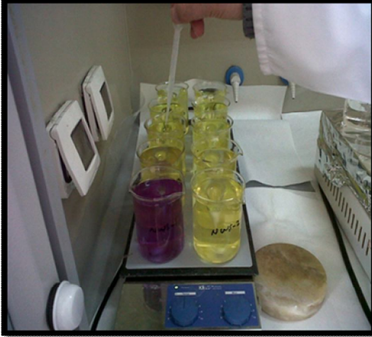
Şekil 3.5. Çözeltilerin 6 N \text{NH}_4\text{OH} ilave edilmiş hâli
