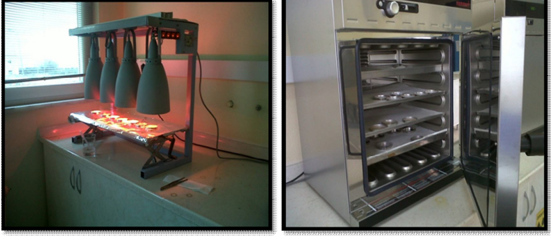
Şekil 3.8. Kızılötesi lamba altında buharlaştırılan ve ısıtıcıda sabit tartıma getirilen planşetler içindeki örnekler
