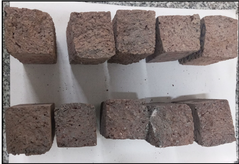
Şekil 3.11. Yüksek sıcaklık etkisi sonrası harçların görünümü
