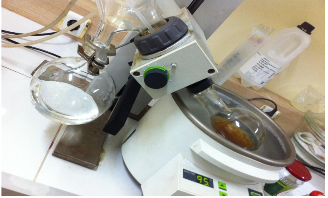
Şekil 2. 3. Rotary evaporatörde uçurma işlemi
