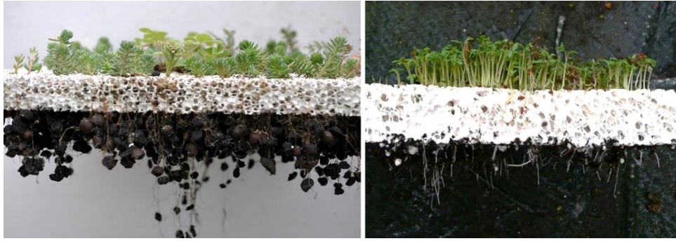
Resim 6: Kaufmann ve HEPIA araştırmacılarının iş birliğiyle geliştirilen seramik ve elyaf (fiber) katkılı yeşil dikey duvar kesiti, 2008, İsviçre (“Principle of the skyflor plant envelope,” 2012; Kaufmann, 2008).
