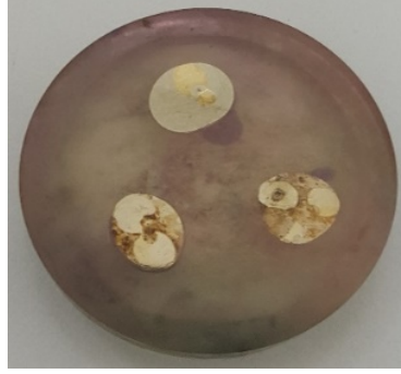
Şekil 3.3. Epoksi ile kalıplanarak metalografik işlemlere tabi tutulan numune
