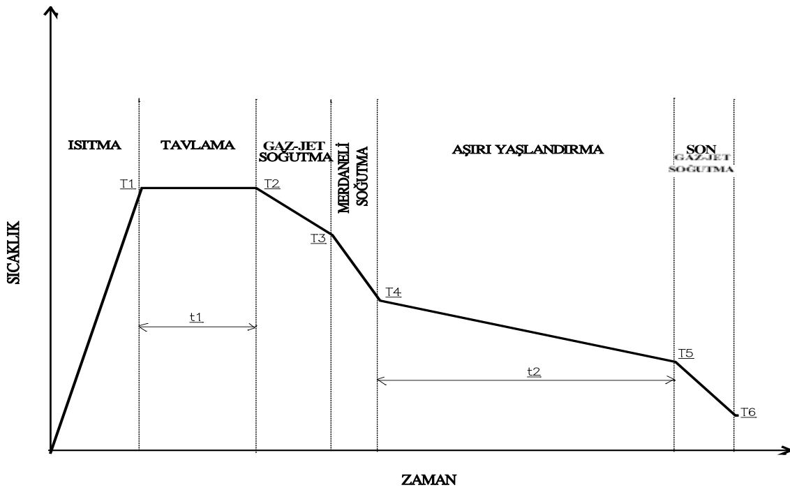
Şekil 2.16.Şekil 11. ERDEMİR sürekli tavlama hatlarının şematik gösterimi
