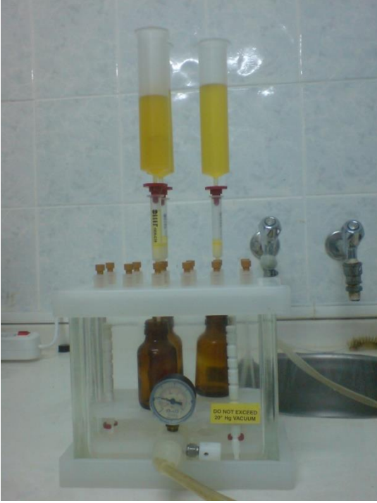
Şekil 3.6. Bağlı aroma maddelerinin ekstraksiyonu
