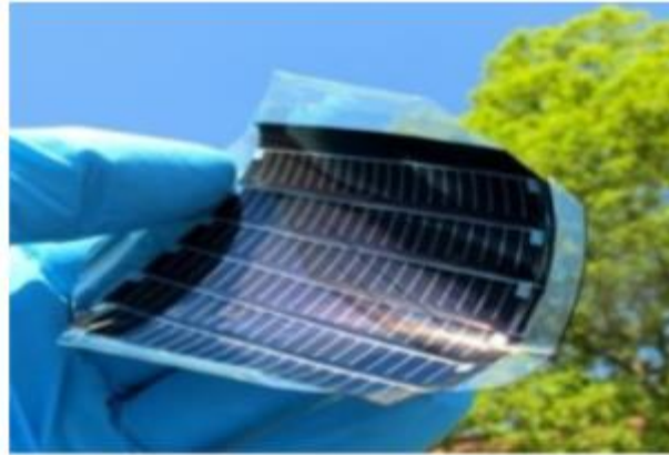
Şekil 2.10. Kadmiyum-Tellür FV hücresi [21]
