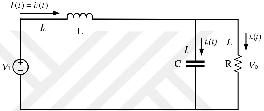
Şekil 4.4. Yükselten konvertörün kesim durumundaki devre yapısı
